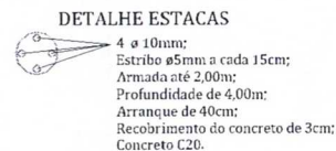
DETALHE ESTACAS
